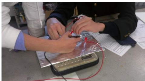
図3 アルミ箔を用いた等電位線探査の様子
