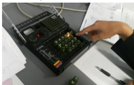
図2 電子ブロックでの回路製作
